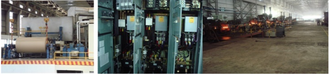
ภาพแสดงการเปลี่ยนระบบการควบคุมเครื่องจักรเก่าโดยการเปลี่ยนเป็น Digital Drives พร้อมระบบ PLC และระบบรายงานผลจากคอมพิวเตอร์
