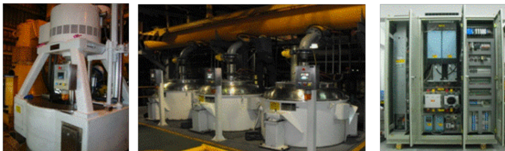
ภาพแสดงระบบ Regenerative Inverter ควบคุมความเร็วโดยระบบ PLC และการสื่อสารกับระบบรายงานผลจากคอมพิวเตอร์
